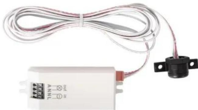
Ce détecteur de présence 230V permet de détecter la présence d'une porte à moins de 5cm et d'allumer une lumière (non fournie) lorsqu'il ne détecte plus la présence de la porte, c'est à dire qu'il allume une lumière lorsque la porte est ouverte.
